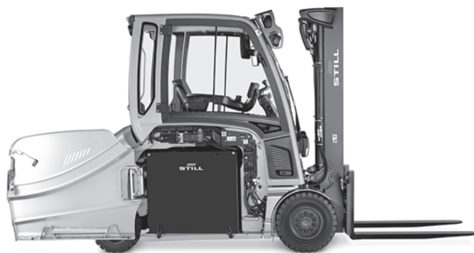
Оптимальная эксплуатационная готовность благодаря быстрой и безопасной смене батарей
