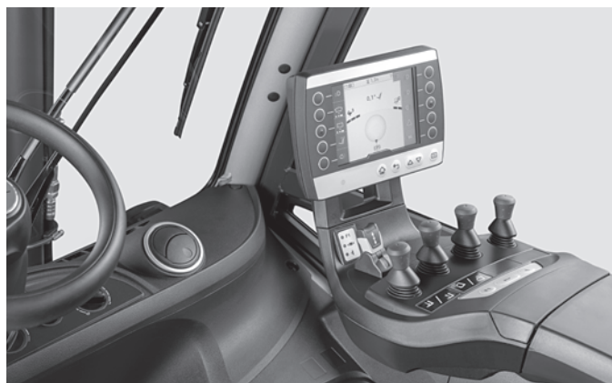
Безопасное и интуитивное управление с помощью модуля индикации и управления STILL Easy Control
